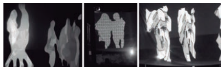
Figura 12 – Exemplos de imagens de preenchimento dos contornos capturados pelos sensores do Kinect e pela câmera.
